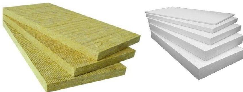
В качестве теплоизоляционного материала для систем утепления фасада хорошо зарекомендовали себя плиты из пенополистирола и минерального волокна (каменной ваты). Выбор этих плит весьма разнообразен как по формату, так и по коэффициенту теплопроводности. Кроме того, при выборе соответствующего материала утеплителя
