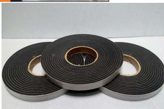
Применение саморасширяющейся уплотнительной ленты в местах примыкания системы к строительным элементам хорошо зарекомендовало себя, так как использование ленты весьма удобно. Эта самоклеящаяся лента покрыта с одной стороны клейким составом. Во всех местах примыкания и соединения уплотнительная лента должна плотно прилегать к изоляционному материалу, не выступая за его поверхность. В углах
